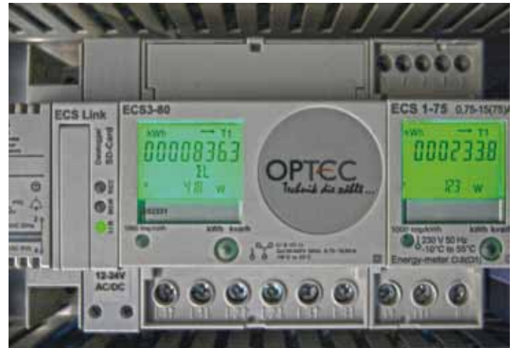
Illustration 121: Appareil de mesure de l'énergie et de la puissance avec en- registreur de don- nées pour carte SD.
