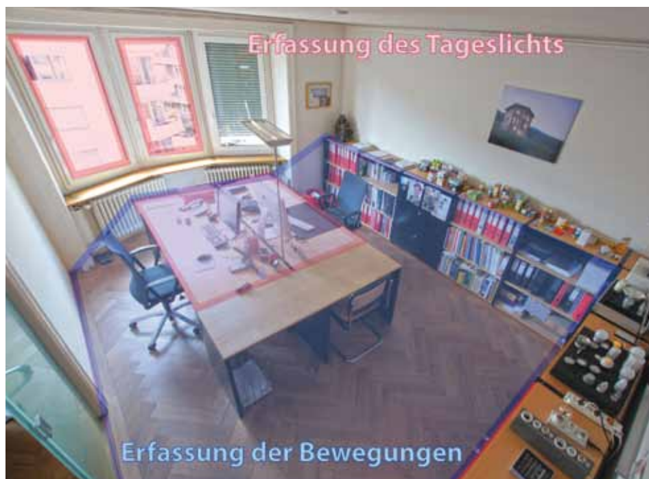
Illustration 115: Enregistrement précis du local au moyen d'un capteur CCD et du traitement de l'image.
